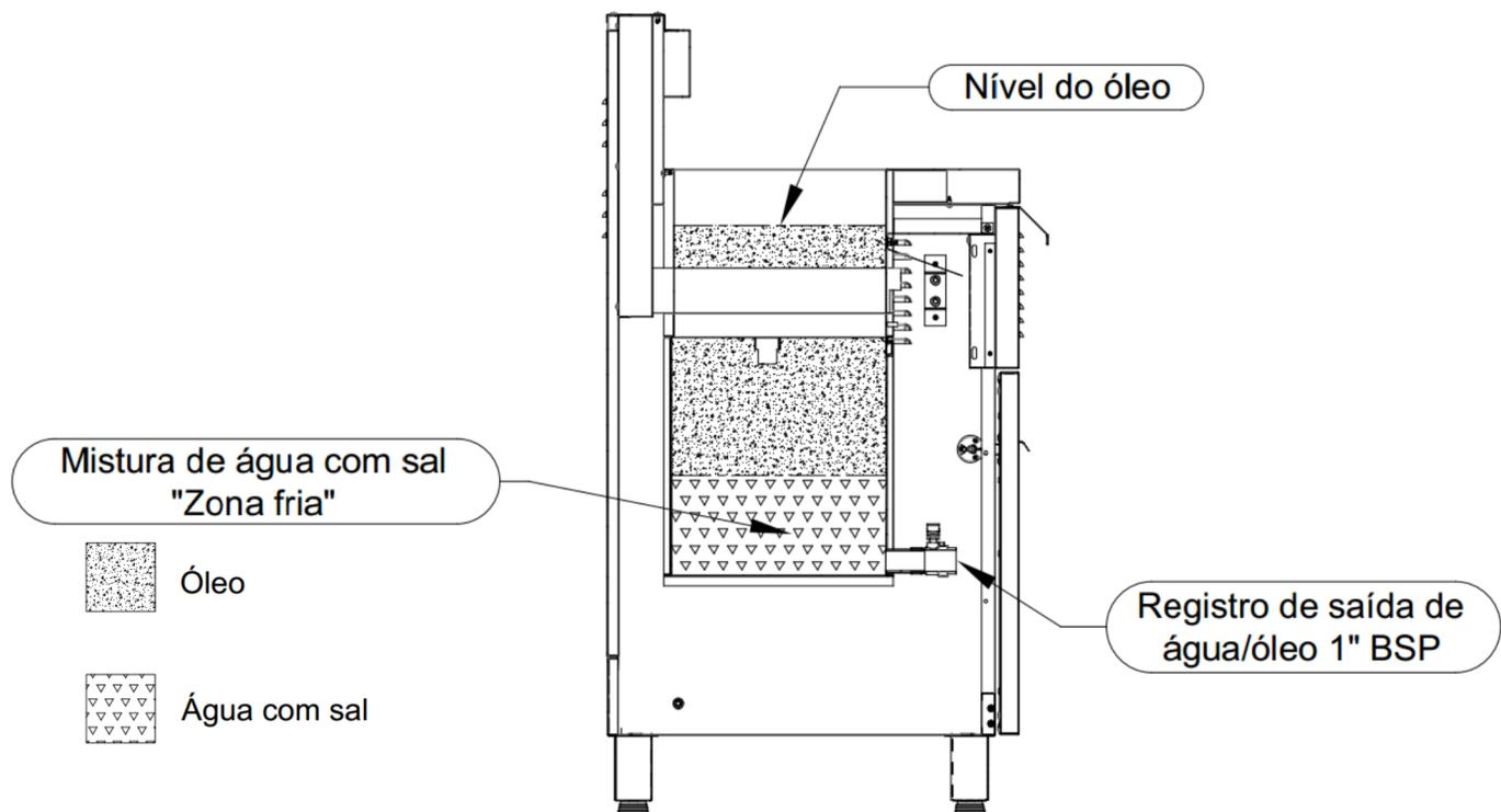
**NOTA:** Conforme procedimentos descritos na seção 5, é proibida a utilização de água no fritador profissional a óleo (modelo "F"). Utilize apenas óleo vegetal para seu funcionamento.
