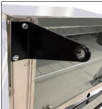
2) Encaixe o eixo da porta (fig.2), por entre o orifício existente no manipulador.
