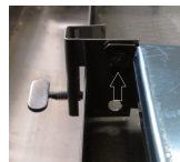
Encaixe o outro suporte na prensa em seguida aperte o parafuso na chapa.
